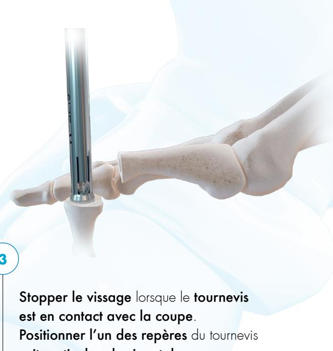
Stopper le vissage lorsque le **tournevis** est en contact avec la coupe.
